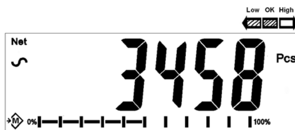
Kontrollwägung im Stückzählmodus
